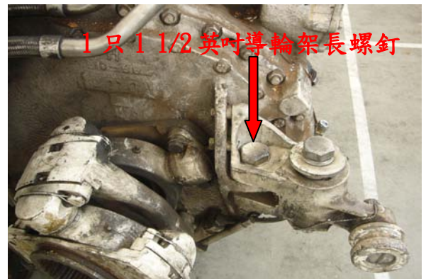
圖七十八變速箱導輪架長螺釘 上緊 380 磅-呎扭力
