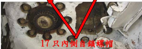
圖三十七最終傳動器內側自鎖螺帽上緊 460-500 磅-呎扭力
