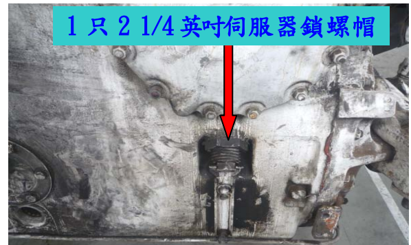
圖五十四變速箱伺服器鎖螺帽 上緊 150 磅-呎扭力
