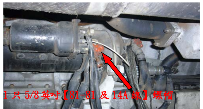
圖五十五起動馬達螺管線圈 B 點螺帽，上緊 14-16 磅-呎扭力
