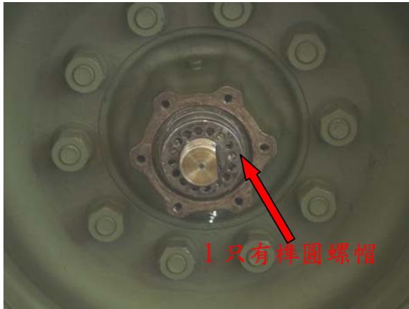
圖五十九輪轂內有樺圓螺帽 上緊 50-70 磅-呎扭力
