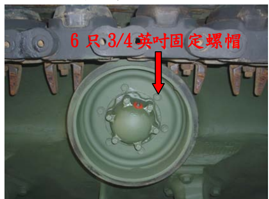
6 只 3/4 英吋固定螺帽 圖十四支輪固定螺帽 上緊 125-135 磅-呎扭力
