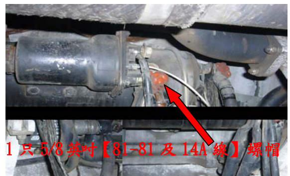
圖八十二起動馬達螺管線圈 B 點螺帽， 上緊 14-16 磅-呎扭力
