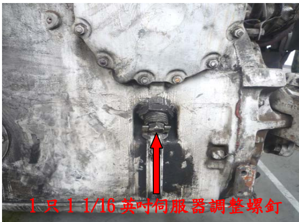
圖八十變速箱伺服器調整螺釘 上緊 30 磅-呎扭力
