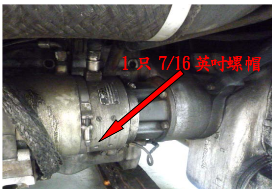
圖八十四發電機 V 型帶管夾螺帽 上緊 60-65 磅-呎扭力
