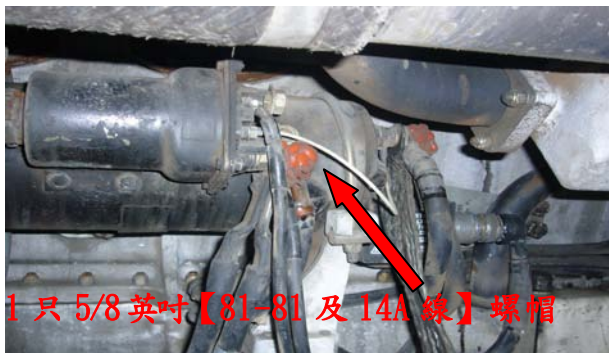
圖二十九起動馬達螺管線圈 B 點螺帽 上緊 14-16 磅-呎扭力
