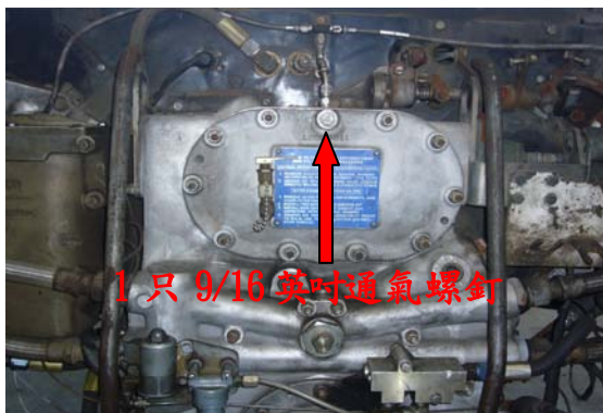
圖四十七引擎機油濾清器通氣 螺釘上緊 175 磅-吋扭力
