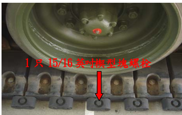
圖七十終端連結楔型塊螺栓 上緊 180-200 磅-呎扭力
