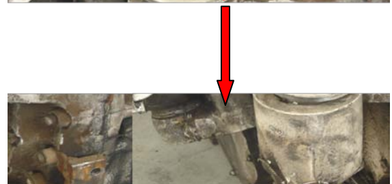
圖五十二變速箱安裝導輪架固定螺帽，上緊 126 磅-呎扭力
