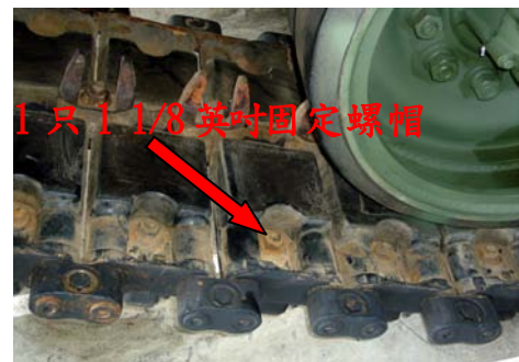
圖六十九履帶膠塊固定螺帽 上緊 260-280 磅-呎扭力
