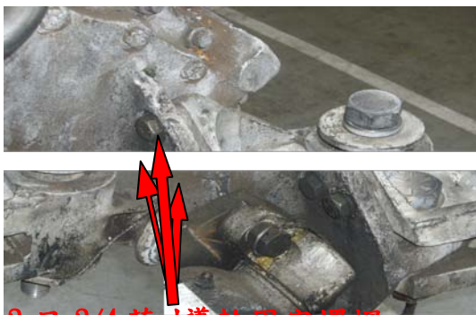
3 只 3/4 英吋導輪固定螺帽 圖七十七變速箱導輪固定螺帽 上緊 70 磅-呎扭力
