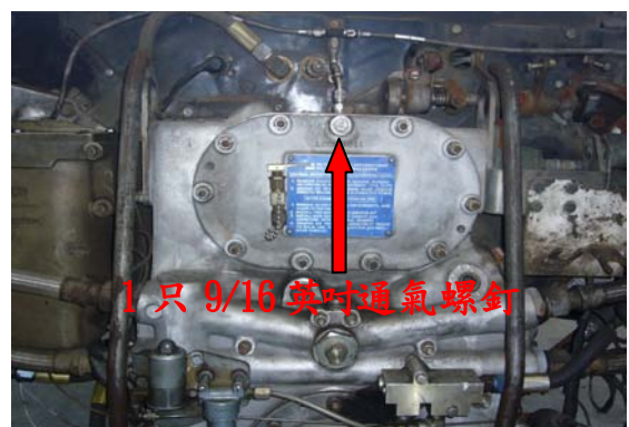
圖二十一引擎機油濾清器通氣 螺釘上緊 175 磅-呎扭力
