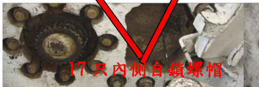
圖六十三最終傳動器內側自鎖螺帽 上緊 460-500 磅-呎扭力
