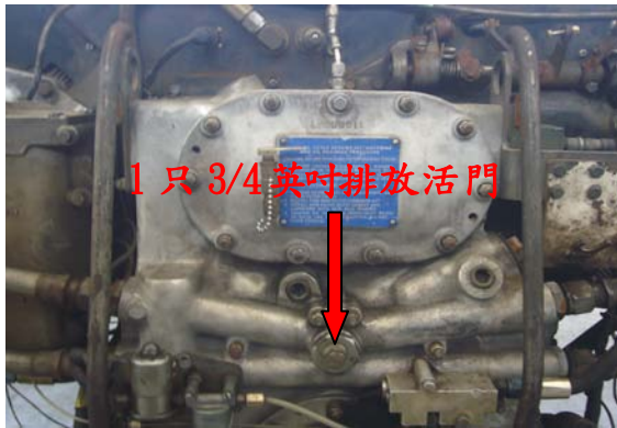
圖四十六引擎機油濾清器排放活門 螺栓，上緊 150 磅-吋扭力
