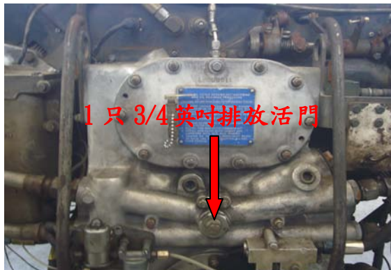
圖七十三引擎機油濾清器排放活門螺栓上緊 150 磅-吋扭力
