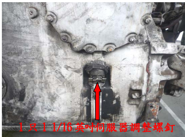
圖五十三變速箱伺服器調整螺釘 上緊 30 磅-呎扭力
