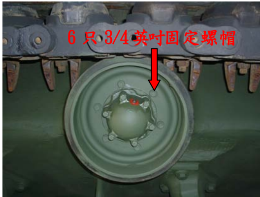
圖六十六支輪固定螺帽 上緊 125-135 磅-呎扭力
