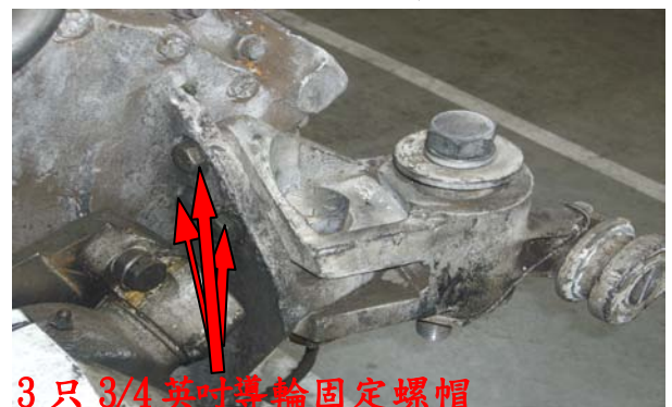
圖二十四變速箱導輪固定螺帽 上緊 70 磅-呎扭力
