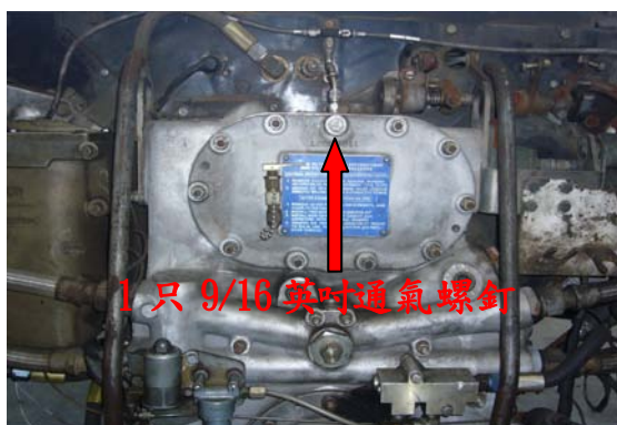
圖七十四引擎機油濾清器通氣螺釘上緊 175 磅-吋扭力
