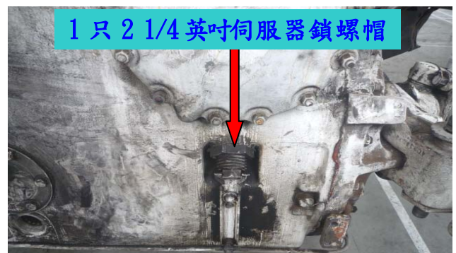
圖二十八變速箱伺服器鎖螺帽 上緊 150 磅-呎扭力
