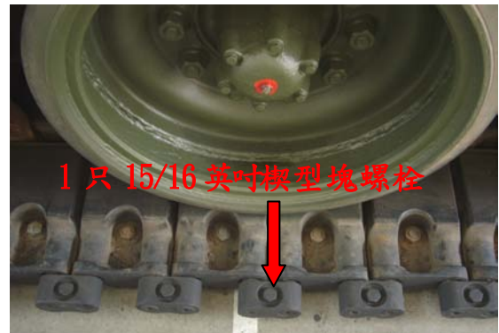
圖四十四終端連結楔型塊螺栓 上緊 180-200 磅-呎扭力
