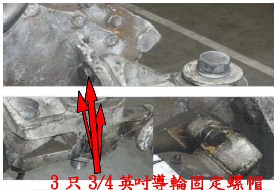
圖五十變速箱導輪固定螺帽 上緊 70 磅-呎扭力
