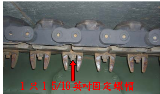
圖七十一中央導尺固定螺帽 上緊 350-380 磅-呎扭力
