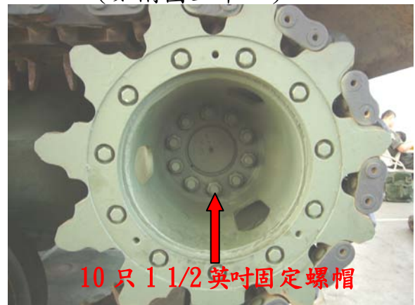
圖三十八主動輪殼固定螺帽上緊 450-470 磅-呎扭力
