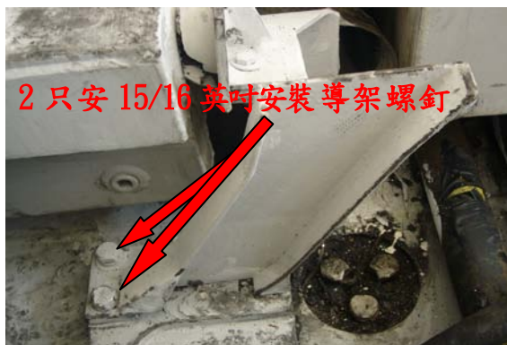
圖二十三引擎機殼安裝導架螺釘 上緊 155-210 磅-呎扭力
