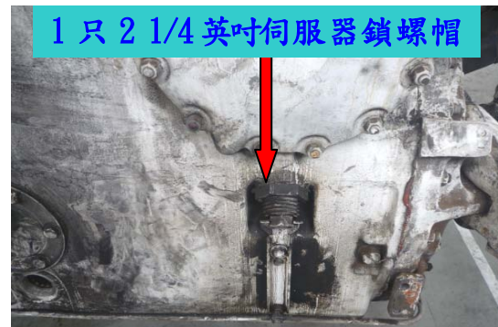
圖八十一變速箱伺服器鎖螺帽 上緊 150 磅-呎扭力
