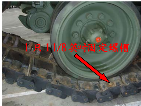
圖四十三履帶膠塊固定螺帽 上緊 260-280 磅-呎扭力
