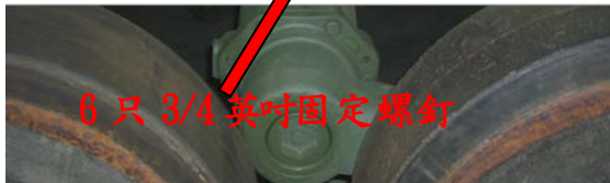
圖三十六承載臂外殼固定螺釘上緊 96-124 磅-呎扭力
