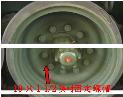
圖三十二固定螺帽 上緊 450-500 磅-呎扭力
