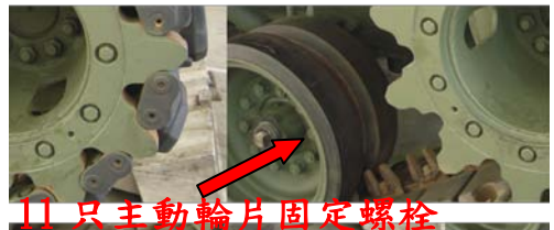
圖六十五主動輪片螺栓 上緊 140-190 磅-呎扭力
