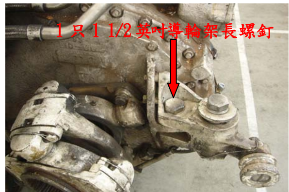
圖五十一變速箱導輪架長螺釘 上緊 380 磅-呎扭力
