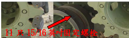
圖三十九主動輪片螺栓 上緊 140-190 磅-呎扭力
