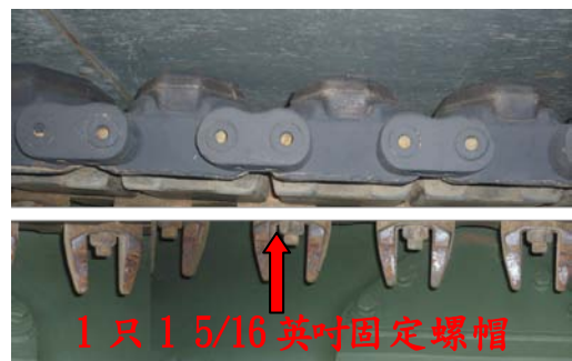
圖四十五中央導尺固定螺帽 上緊 350-380 磅-呎扭力
