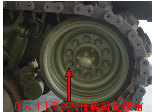
圖六十八惰輪固定螺帽 上緊 450-500 磅-呎扭力
