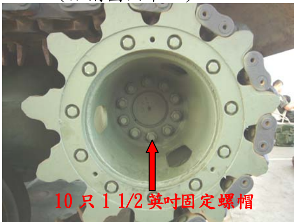
圖六十四主動輪轂固定螺帽 上緊 450-470 磅-呎扭力
