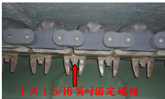
圖十九中央導尺固定螺帽 上緊 350-380 磅-呎扭力
