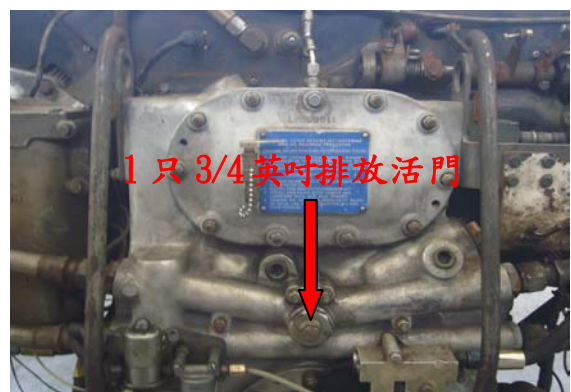
圖二十引擎機油濾清器排放活門 螺栓上緊 150 磅-呎扭力
