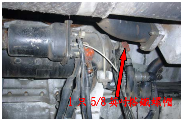
圖八十三起動馬達搭鐵螺帽 上緊 14-16 磅-呎扭力
