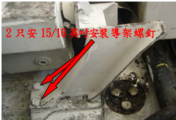
圖四十九引擎機殼安裝導架螺釘 上緊 155-210 磅-呎扭力
