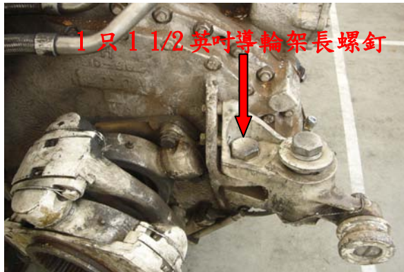
圖二十五變速箱導輪架長螺釘 上緊 380 磅-呎扭力
