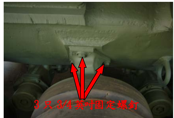
圖七十二渦型緩衝簧固定螺釘 上緊 150 磅-呎扭力
