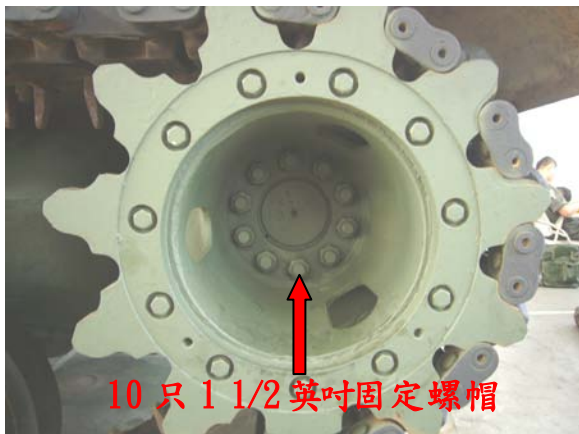
10 只 1 1/2 英吋固定螺帽 圖十二主動輪殼固定螺帽 上緊 450-470 磅-呎扭力
