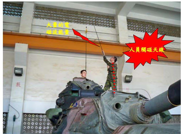
圖八：人員觸碰天線導入電磁波 (資料來源：作者自行繪製)
