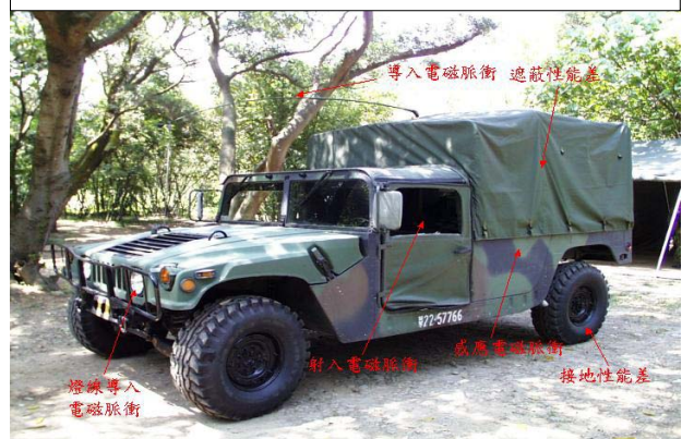
圖十：無線電台通信車感應電磁脈衝示意圖(資料來源：作者自行繪製)
