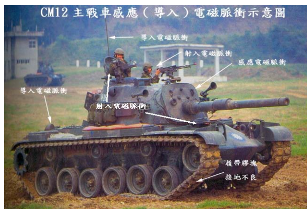
圖五：戰車外觀感應電磁脈衝示意圖（資料來源：作者研究整理）
