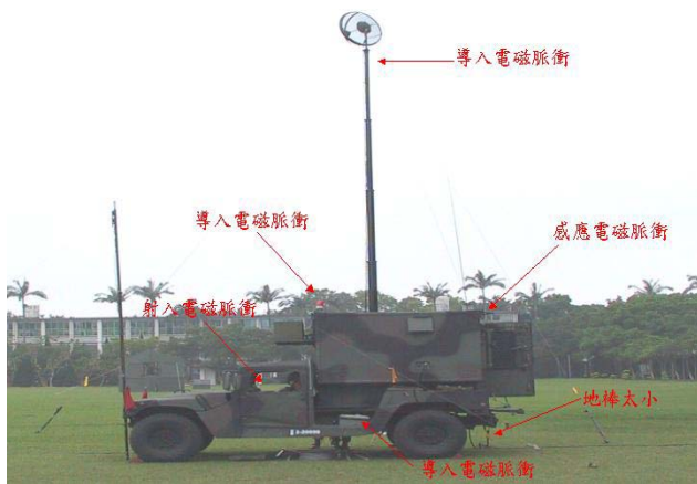
圖十一：CTM-218 多波道通信車感應電磁脈衝示意圖(資料來源：作者自行繪製)
