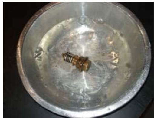
圖四：將節溫旁通活門總成放置於臉盆內之熱水，使其加熱膨脹。 (資料來源：作者自攝)
