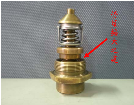
圖五：活門總成加熱後管徑擴大之處 （資料來源：作者自攝）
