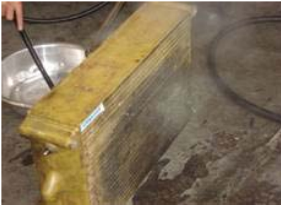
圖九：壓下控制槓桿使空氣與清潔劑混合，並以清潔劑將散熱片浸透。使清潔溶液有足夠之時間可以滲入機油冷卻器散熱片之間。 (資料來源：作者自攝)
