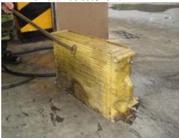
圖十：交錯由前向後移動清潔器噴頭，直至清潔溶液可以由機油冷卻器另一側散熱片順暢流出整個機油冷卻器範圍為止。
