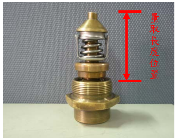
圖三：節溫旁通活門總成量取長度之位置 (資料來源：作者自攝)
