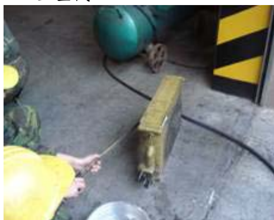
圖七：將機油冷卻器清洗器進氣口連接至 50-90psi（平方吋磅）之空壓機。 （資料來源：作者自攝）
