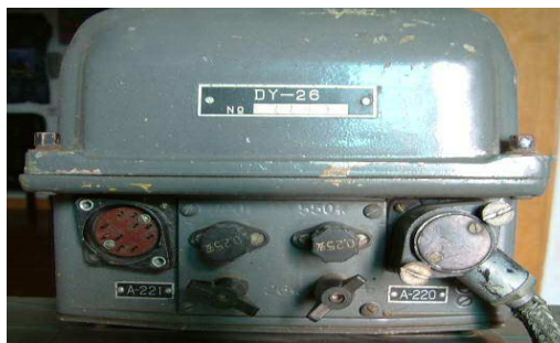
圖(二) DY-26 電源裝置
