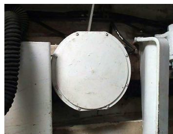
圖三:CM11/12 及 M60A3TTS 角速度儀 (作者拍攝)
