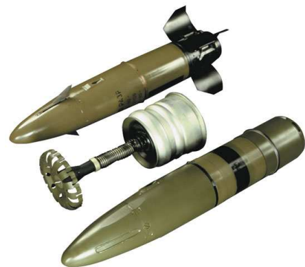
圖 21：可清楚區分砲射導彈發射前後的彈體外觀 資料來源： http://www.baido.com/china/army-weapon-technology/missile-9M112-13.jpg
