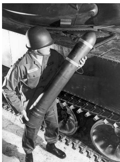
圖 41：世界上第一發砲射導彈-美製橡樹棍砲射導彈
