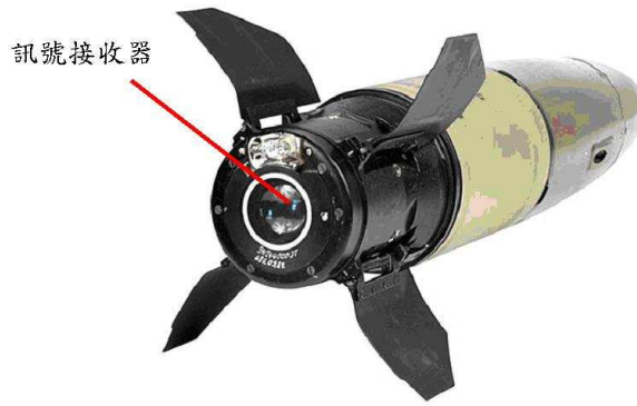
圖 19：指揮導引的砲射導彈接收端在尾部，彈體內不需要有繁雜的電子機件。 資料來源：作者研究整理
