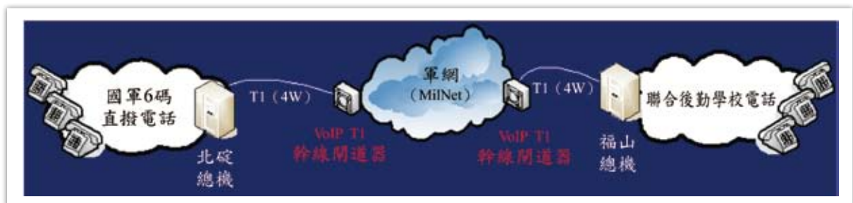
圖五 北碇總機以「VoIP」開道器連結福山總機示意圖
