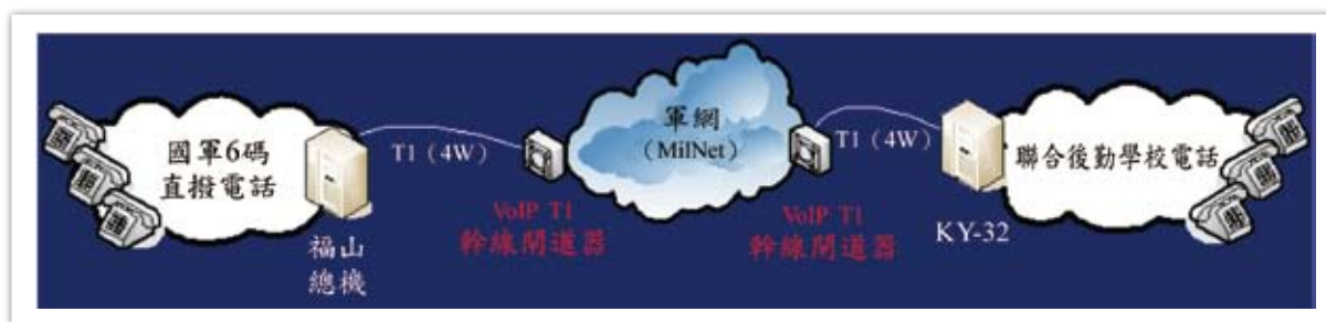
圖七 福山總機以「VoIP」開道器連結聯合後勤學校KY-32示意圖
