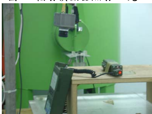
圖五 輻射偵檢器照射校正射源鈷 60
