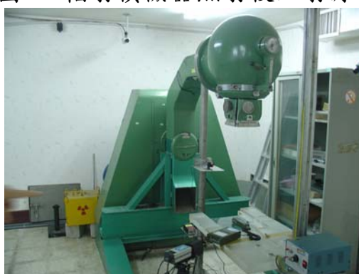
圖六 輻射偵檢器照射校正射源銫 137
