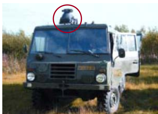
圖六 布魯克公司研製之HAWK遠距遙感毒劑警報器（含車載架）及該系統搭配於載台上之情形（註14）。
