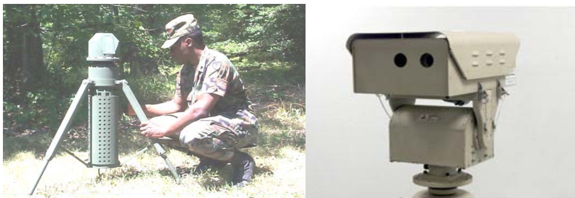
圖五 兩款已完成測試階段的 JSLSCAD 遠距遙感毒劑警報器。圖左為美商 GD 公司之產品；圖右為 Block Engineering 公司之 MCAD(由 Tradeway 提供)。
