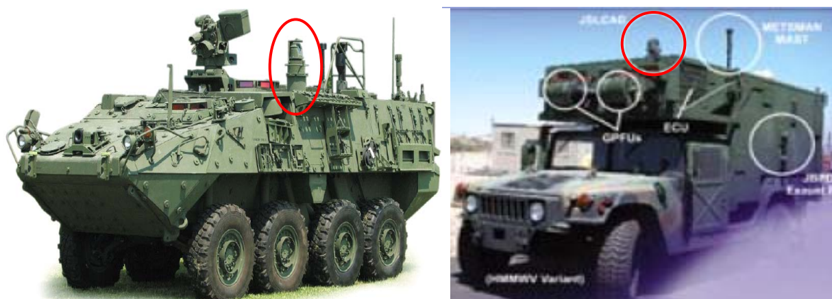
圖八 美軍新一代 Stryker 核生化偵檢車及輕量型核生化偵檢車均採用 JSLSCAD 遙測預警系統。
