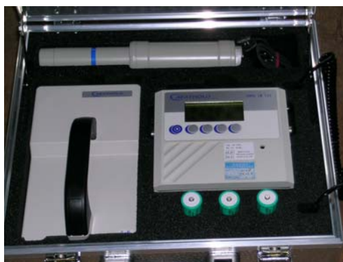
圖 3：LB-123 人體射線偵檢器（資料來源：作者於核安演習時拍攝）
