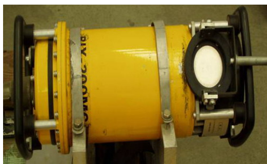
圖 1：飛行機具機械性能檢測 X 光機
