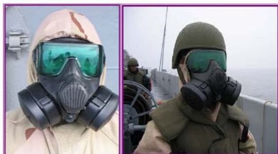
圖6.第二個過濾器過濾乙烯氧化物、氨、甲醛媒介物
