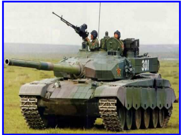
圖十一：99式砲塔有類似豹二A5的楔型裝甲
