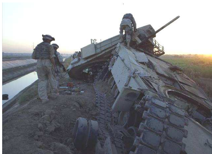
附圖五：遭一枚 550 公斤航空炸彈製作之應急爆炸裝置所摧毀的 M1A2 艾布蘭戰車。 資料來源： http://www.zhjunshi.com/mil/2009-11-10/content6_9184.shtml
