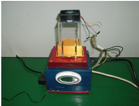
圖八：本研究加裝風管通道之構型照片
