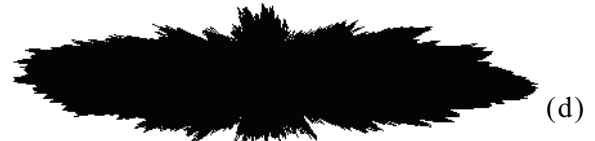
圖 7、不同長短軸、 D 值的橢圓粒子： (a) a=2 , b=1 , D=1.3 , G'=0.04 ；(b) a=2 , b=1 , D=1.7 , G'=0.04 ；(c) a=5 , b=1 , D=1.3 , G'=0.04 ；(d) a=5 , b=1 , D=1.7 , G'=0.04
