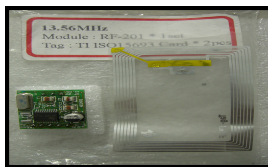
圖七 RFID 模組(RF-201)與 RFID Tag
