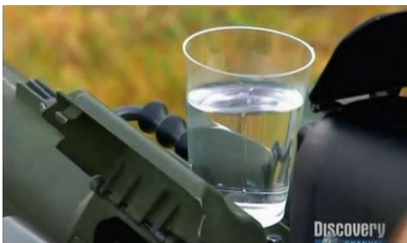
圖六：LW-50 射擊時在槍面線上之水杯只有水面晃動
