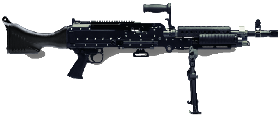
圖七：採用鈦合金製程機匣的 M240E6
