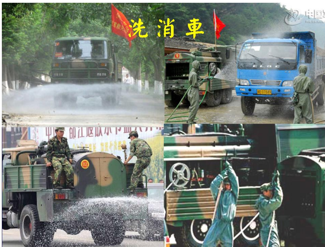
圖 16 洗消車前、後、側面與噴灑作業示意圖
