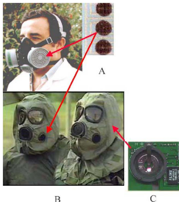
圖 34 Cyrano Sciences 的殘餘壽限指示器(A)濾毒罐內的化學電阻器(B)將化學電阻器或電子鼻整合至全裝防護(C)電子鼻晶片
