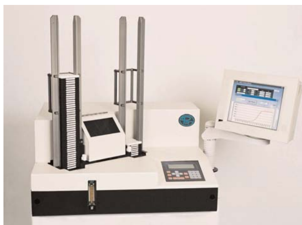
圖 6 低背景 \alpha/\beta 計測系統
