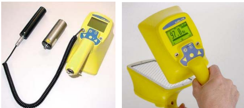
圖 11 表面輻射污染偵測儀(型號 CoMo170)
