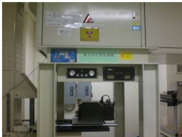
圖8 警報器照射鈷60校正射源
