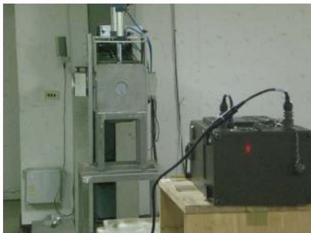
圖7 警報器照射銫137校正射源
