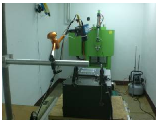
圖6警報器照射銫137校正射源
