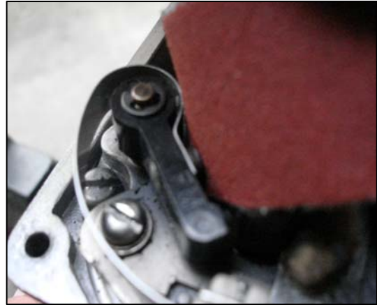
圖 16 斷電臂及接觸點有無凹陷或凸出 圖 17 用細砂布整平表面
