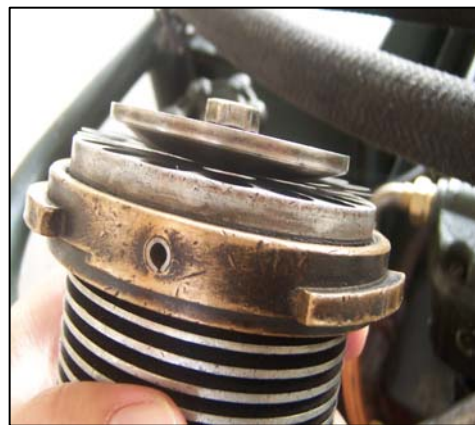
圖 9 引擎活門片變形但無損壞
