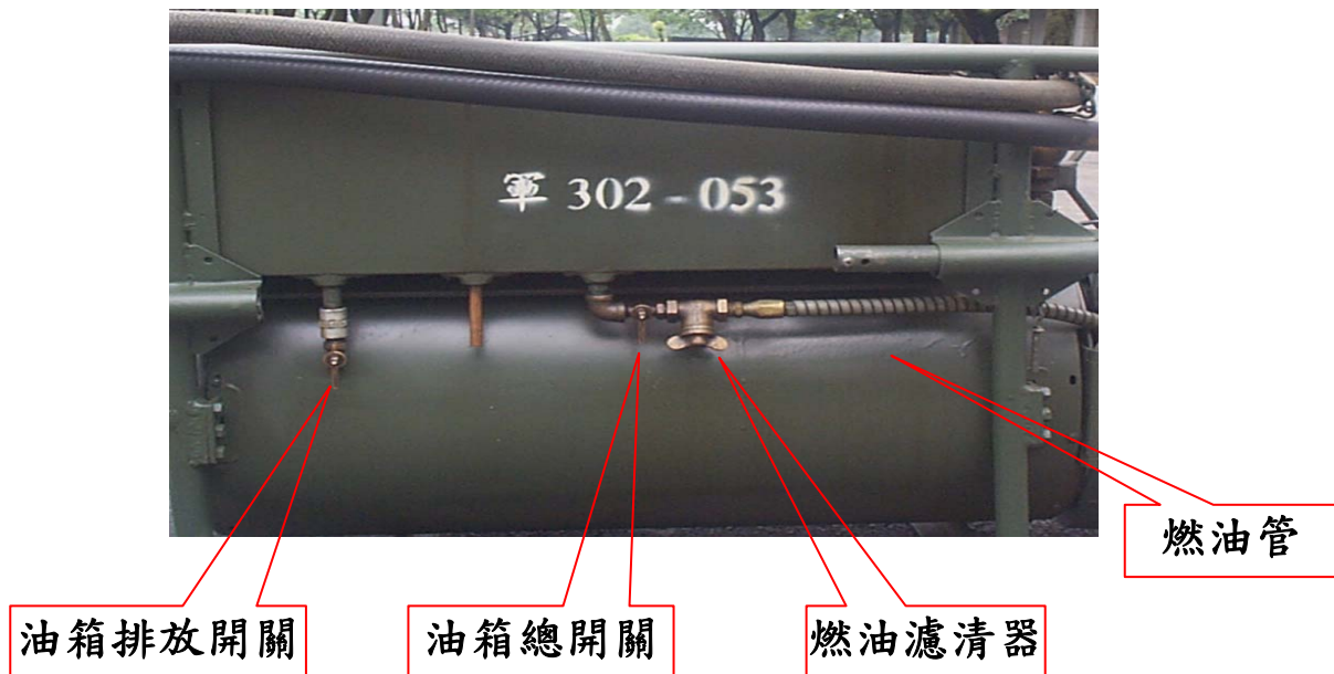
圖 3 燃油系統各元件位置
