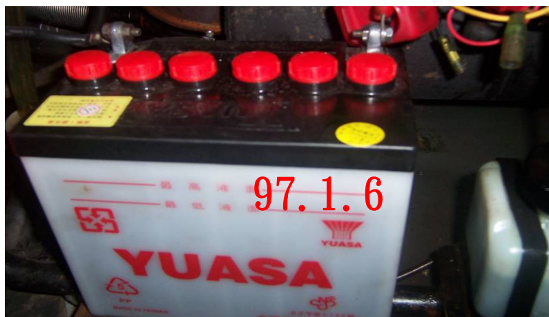
圖 2 將電瓶接頭鎖緊並檢查有無第一次使用日期
