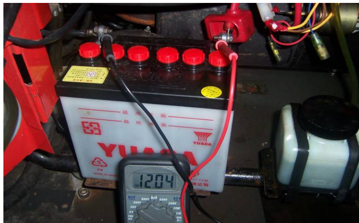
圖 1 以三用電錶測量電瓶
