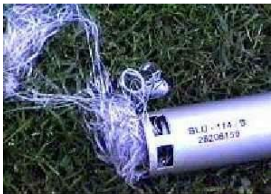
圖二 BLU-114/B 彈體裝填石墨細絲爆炸後現象之一（
