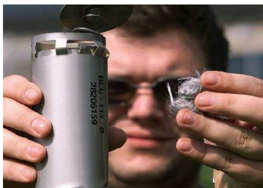
圖一 BLU-114/B 彈體裝填石墨細絲
