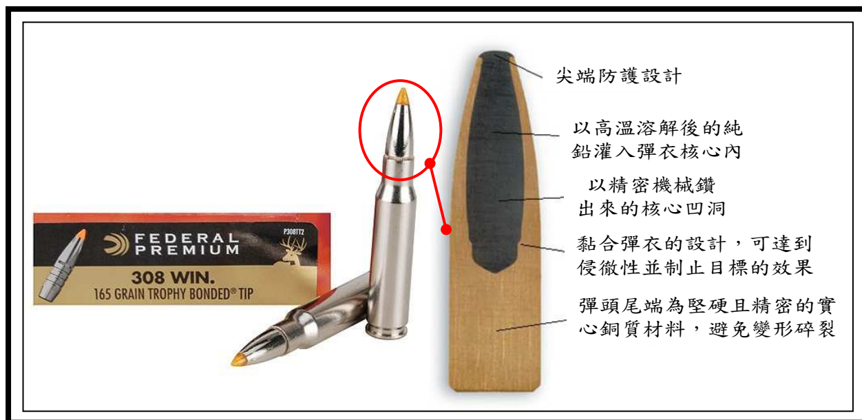
圖十八 Trophy Bonded 彈頭設計剖面示意圖
