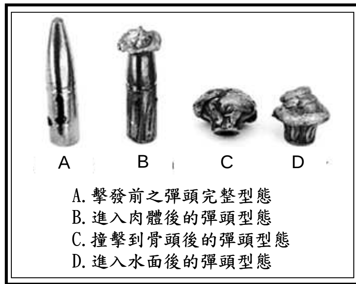
圖十一 Trophy Bonded 子彈於實體驗證後之彈頭型態示意圖
