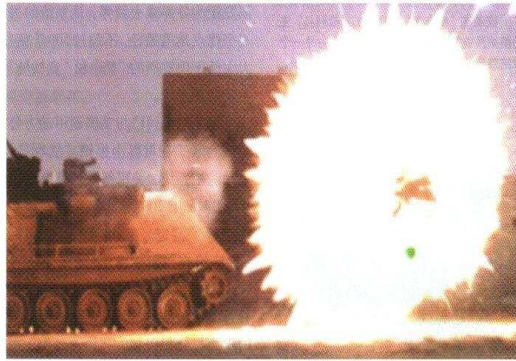
圖六：安裝在 M113 甲車的鐵拳防護系統在近距離攔截 RPG 火箭彈
