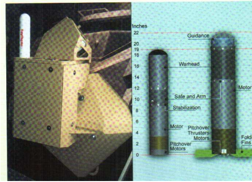
圖七：快殺系統結合主動式雷達與垂直發射智慧彈藥
