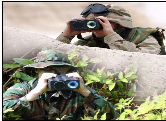
圖十一 馬克” VII 便攜式雷射測距遠望鏡
