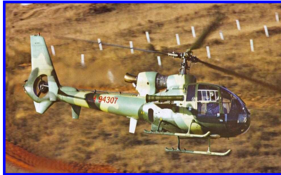
圖十：法製SA324瞪羚式武裝直升機配賦哈特飛彈
