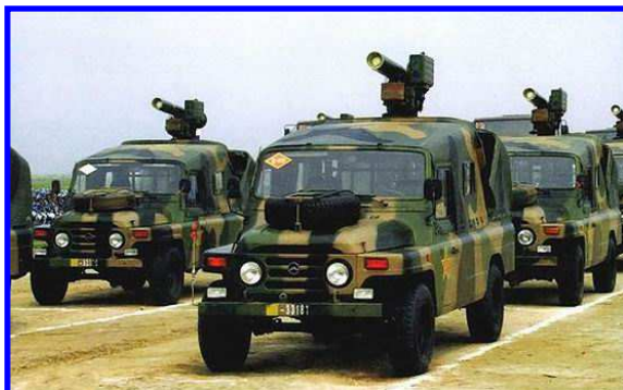
圖七：BJ2020SJ型中吉普搭載紅箭－8E型反裝甲飛彈
