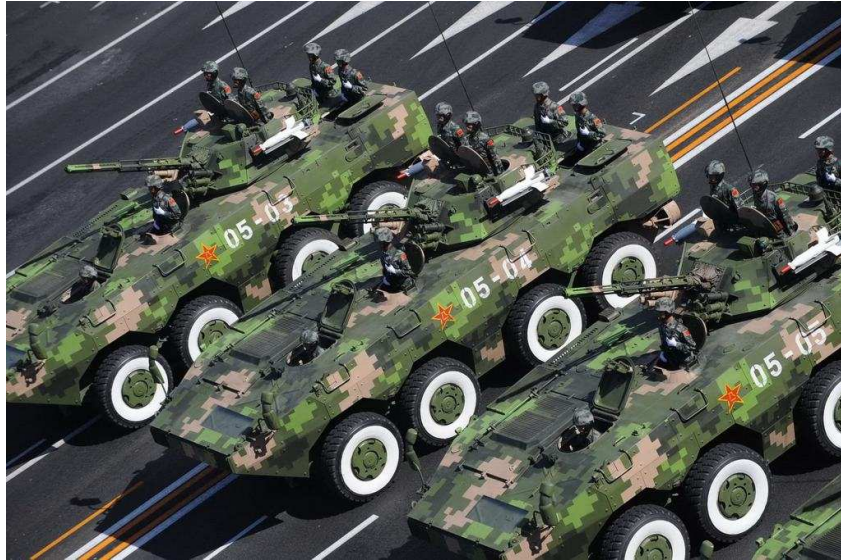
圖五：ZBD-09 輪型步兵戰車在砲塔的兩側各配製一個發射「紅箭」反坦克導彈的滑軌。
