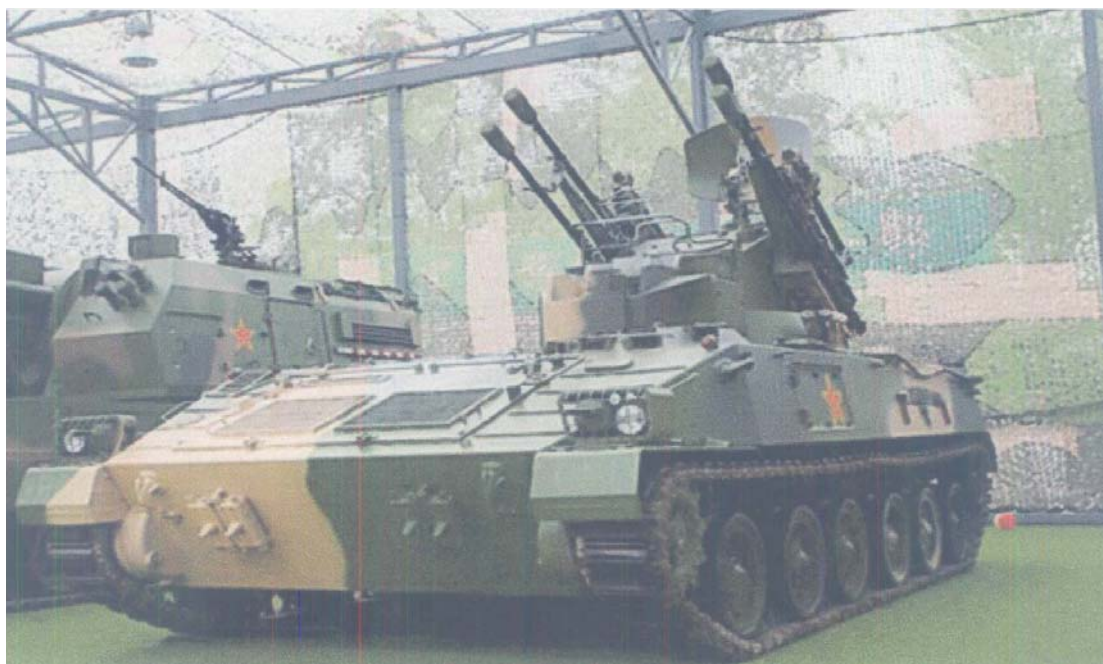
圖四、中共「九五（PGZ-95）式」彈砲整合防空武器系統
