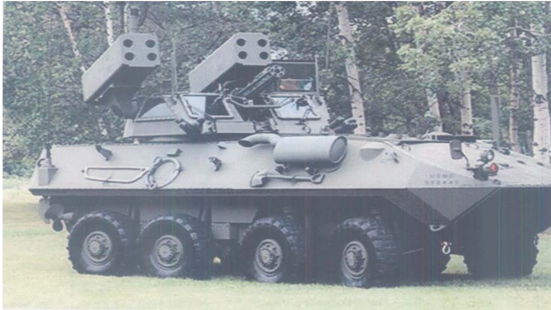
圖五、美製「LAV-AD」防空武器系統
