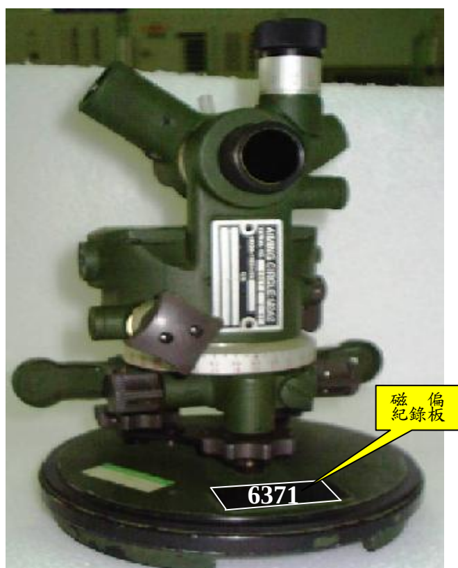
圖六：M2A2 方向盤之「磁偏紀錄板」
