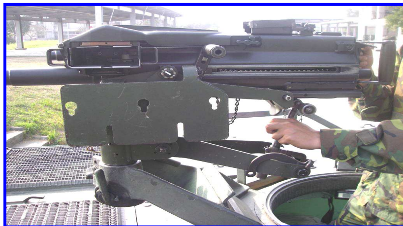
圖七：結合方向、高低機並調整槍身至水平狀態
