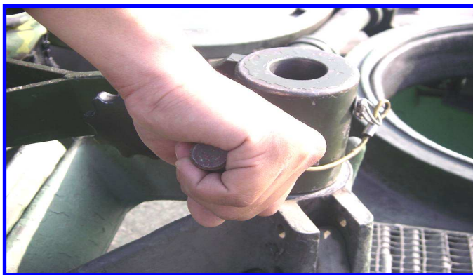
圖四：右手旋緊緊定柄至定位
