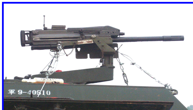
圖一：四〇榴彈機槍配賦於甲車上以鋼索固定示意圖
