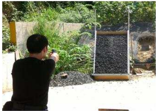
圖六：膠粒測試手槍 25 公尺射擊
