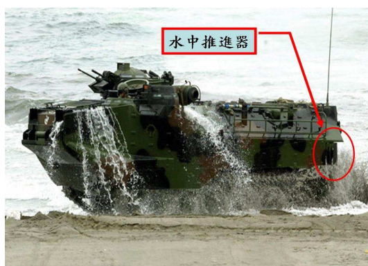
圖四：陸戰隊 AAV7 水中推進器示意圖
