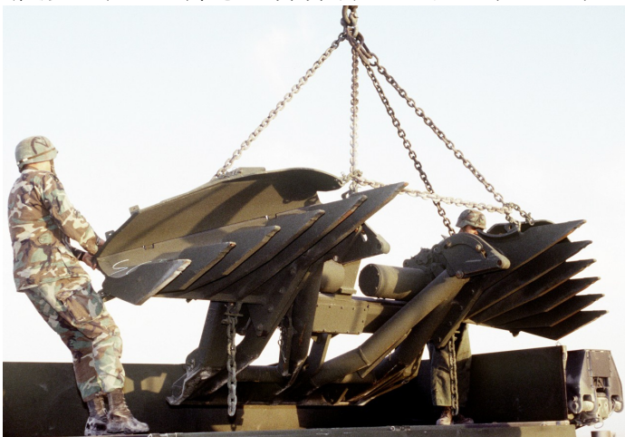
■圖為 M1A1 戰車加裝排雷滾輪(MCR)
