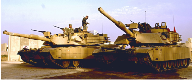
■圖為搭載城鎮生存包件(TUSK)之 M1A1 戰車停駐在伊拉克.巴格達賈達.羅斯塔米亞。
