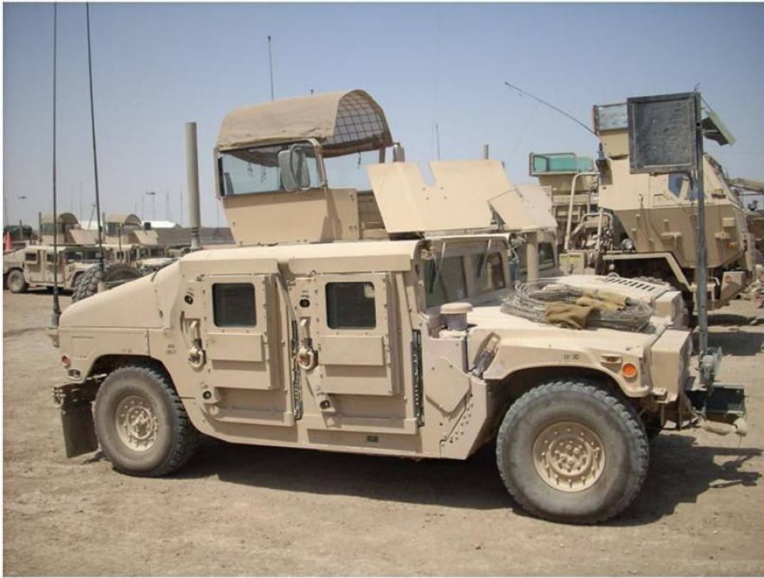
圖 3：美軍 M1114 武裝悍馬車 (M1114 Uparmored HMMWV) 係將軍用悍馬車輛車身上部予以裝甲化，以提升其作戰能力。
