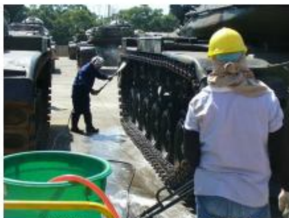
圖 10：以噴灑的方式實施防鏽 10
