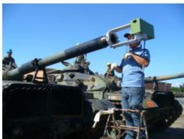
圖 11：封存人員置入 VCI 軟管於砲管內 11
