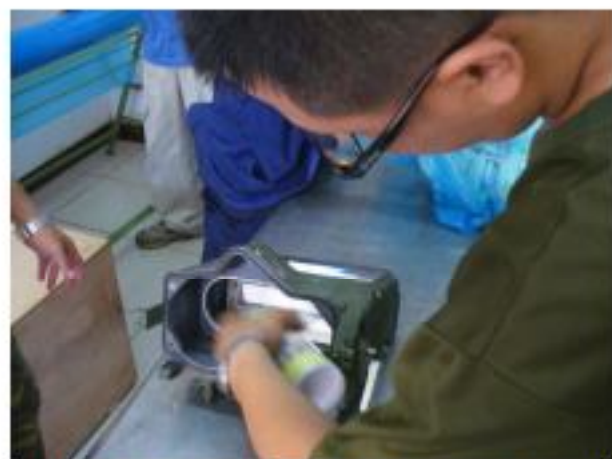
圖 13：將拆卸下的雷射測距機噴上防鏽油 13
