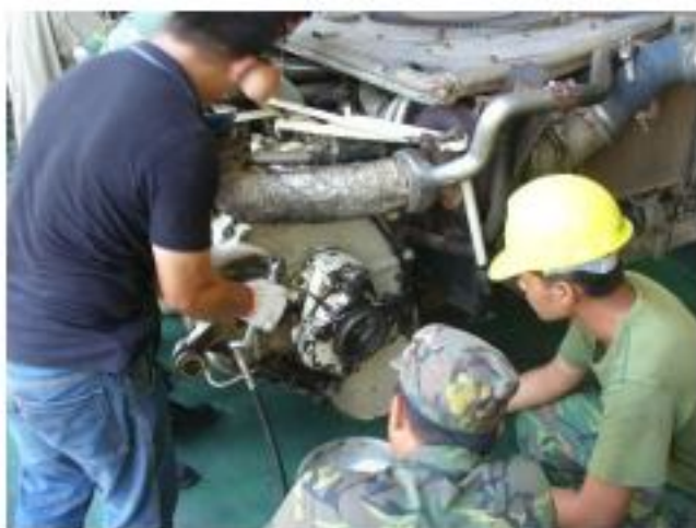
圖 9：由封存公司針對每一個潤滑點逐一潤滑，圖為封存公司使用之電動黃油槍 9
