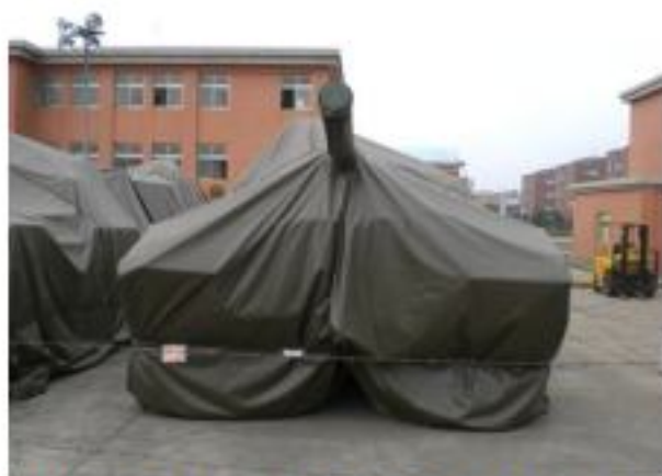
圖 12：在封存的戰車最外圍覆蓋帆布，完成最外圍的封存 12
