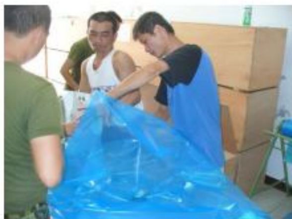
圖 14：將完成防鏽的精密機件置入 VCI 袋 14
