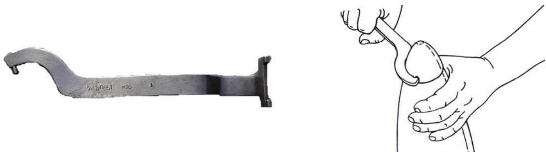
圖十 M16 信管扳手結合信管示意圖
