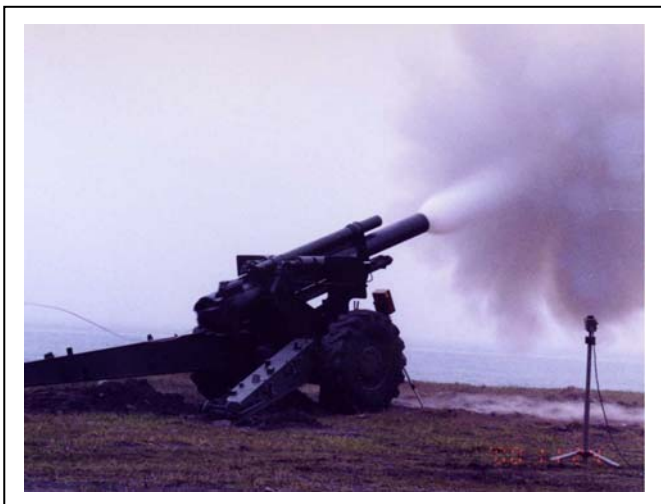
初速測算雷達架設於 155H
