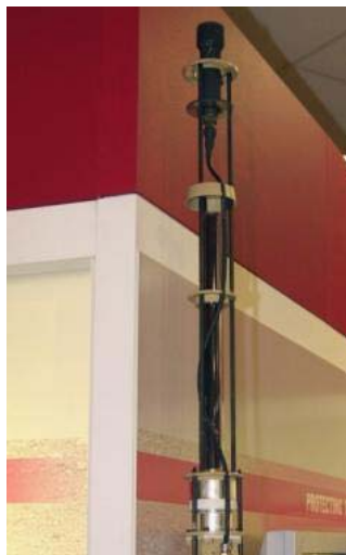
圖六：HALO 感測樁之固裝式氣象感測器
