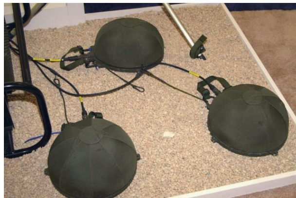
圖四：HALO 感測樁之麥克風集束
