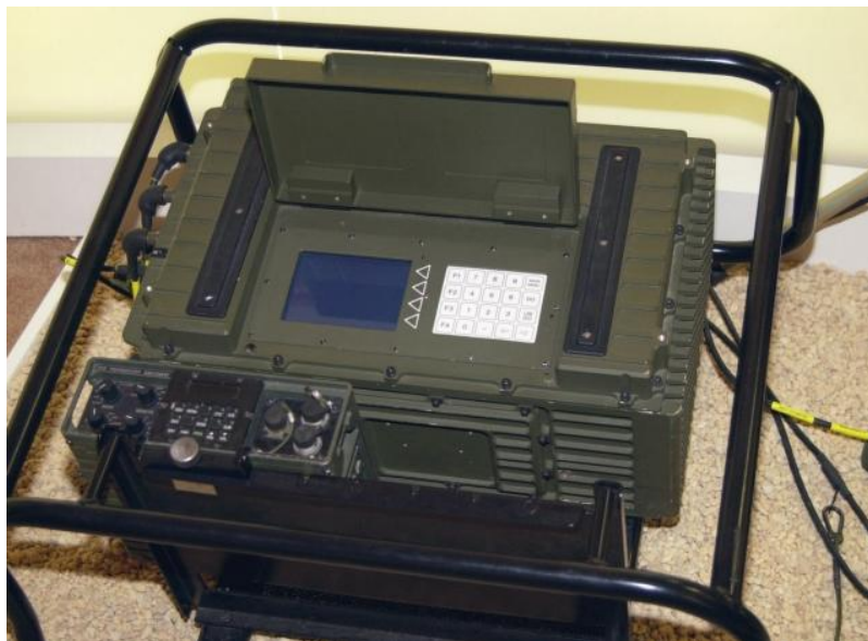
圖五：HALO 感測樁之處理器與無線電機
