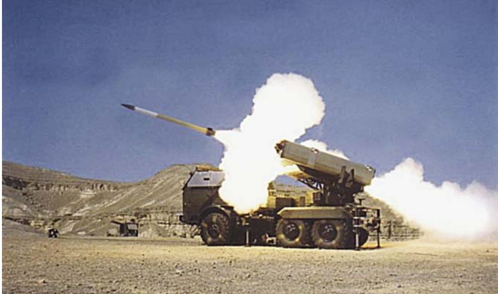
圖五、以色列 AccuLAR 多管火箭系統射擊裝配 TCS 彈道修正系統之 160 mm 火箭彈
