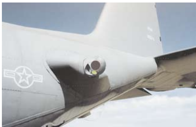
美國空軍特種作戰司令部C-130運輸機機尾，安裝著大型飛機紅外線反制系統追蹤感測器及雷射發射器機座。[7]
