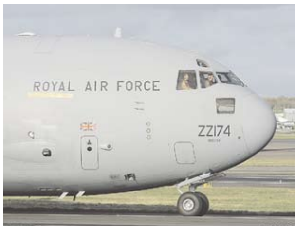
英國空軍C-17運輸機艙門稍後方是大型飛機紅外線反制系統追蹤感測器及雷射干擾器機座，艙門正前方是飛彈逼近警告器。[12]
