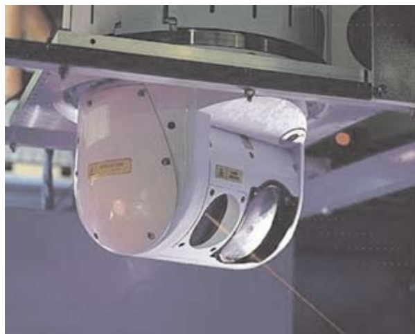
大型飛機紅外線反制系統中的復仇者雷射發射器。[12]
