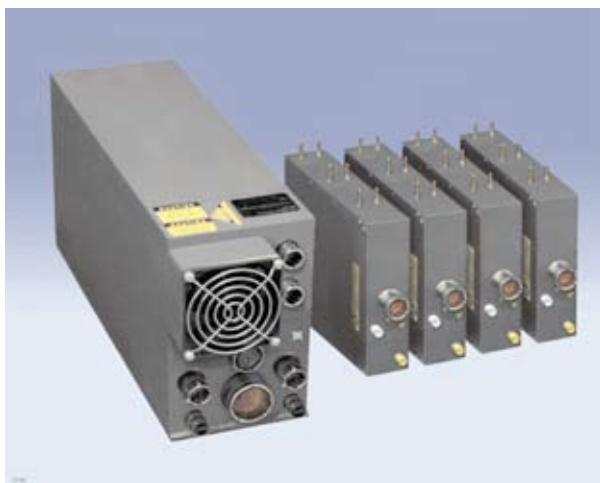
美國最新開發的全數位式AN/ALR-69A(V)雷達警告接收機，預備安裝於C-130運輸機上。[20]
