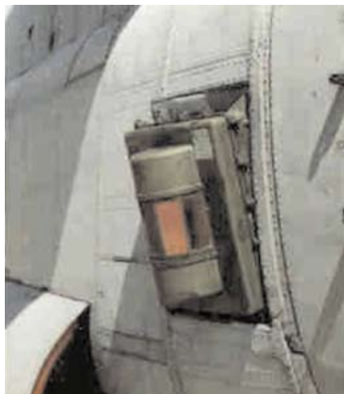
英國空軍C-130機身兩側安裝的AN/ALQ-157紅外線干擾器。[1]
