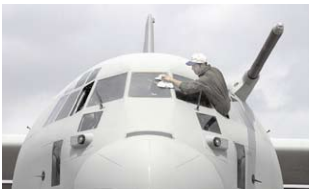
美國海軍陸戰隊C-130J擋風玻璃下方的AAR-47(V)2飛彈逼近警告器。[7]
