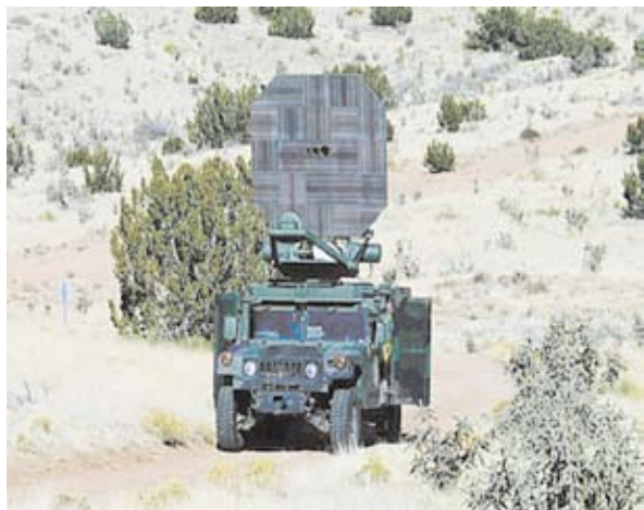
雷神公司「警戒鷹」車載式雷射防護原型系統[16]
