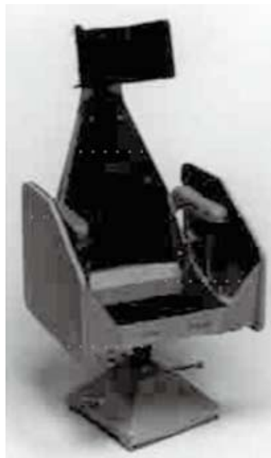
C-130駕駛艙內機組人員的防彈座椅。[1]片(Armourshield)和防彈座椅，它是由防彈級陶瓷和芳香族(Aramid)纖維強化複合材料製成，防護駕駛艙需80到100片。
