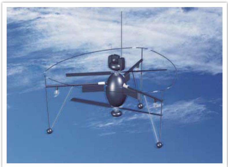
圖五 FanCopter微型無人飛行載具
