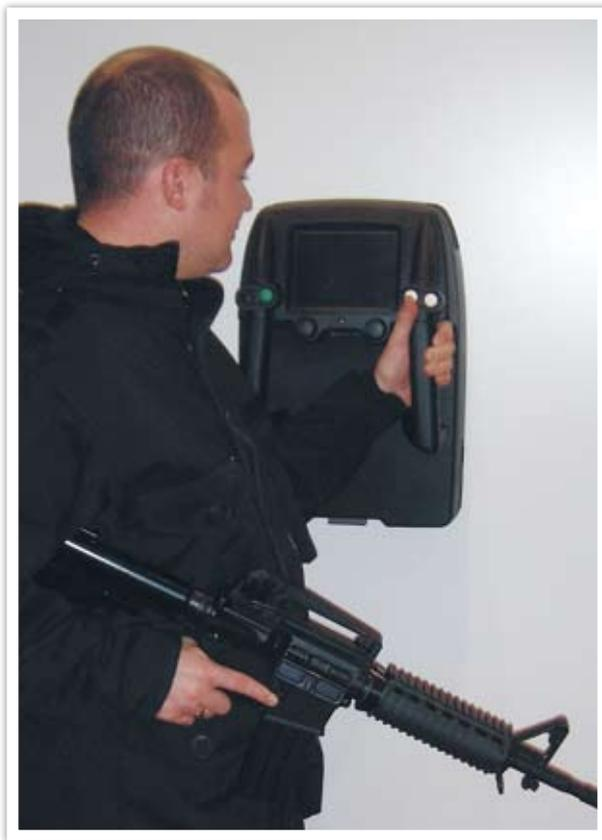
圖二 3D穿牆人體偵測設備<sup>5</sup>
