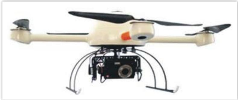
圖四 SensoCopter微型無人飛行載具
