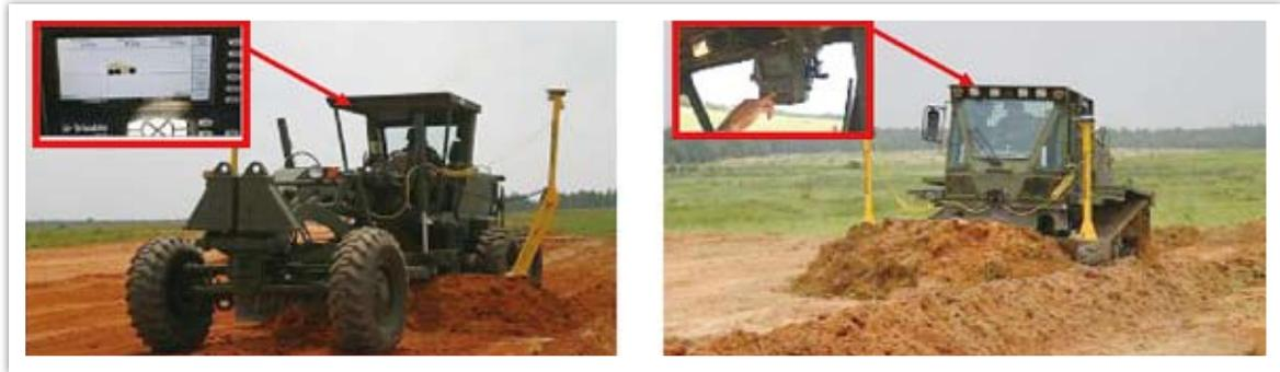
圖廿三 各機械作業手依據顯示器數據作業示意圖
