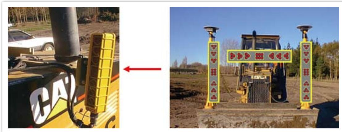
圖十二 LED指引器實體圖實體圖
