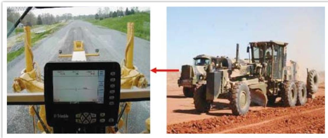
圖七 平路機GPS控制箱及內建軟體圖
