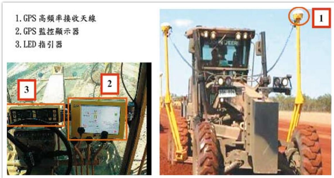
圖廿一 平路機整合系統3大原件配置圖
