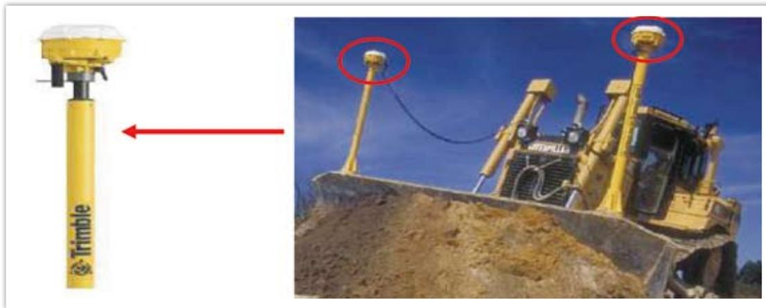
圖十 MS980型GPS高頻率接收天線實體圖
