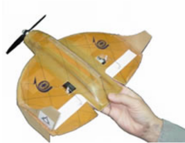
圖 5 以色列研製的「蚊式」(Mosquito)型無人飛行載具 資料來源：defense-update， http://defense-update.com/ ，99 年 8 月 14 日。
