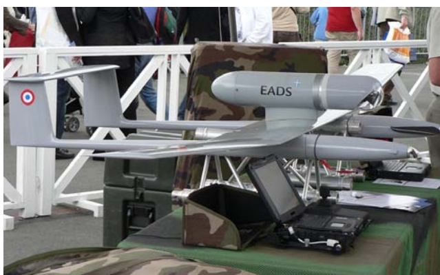
圖 13 法軍現役「追蹤者」(Tracker)輕型無人飛行載具 資料來源：deagel， http://www.deagel.com/ ，99 年 8 月 14 日。
