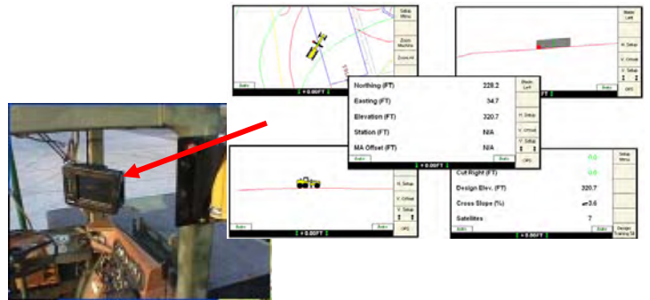
圖 26 以雷射激光器結合 GPS 輔助機具操作精度即時控制實例
