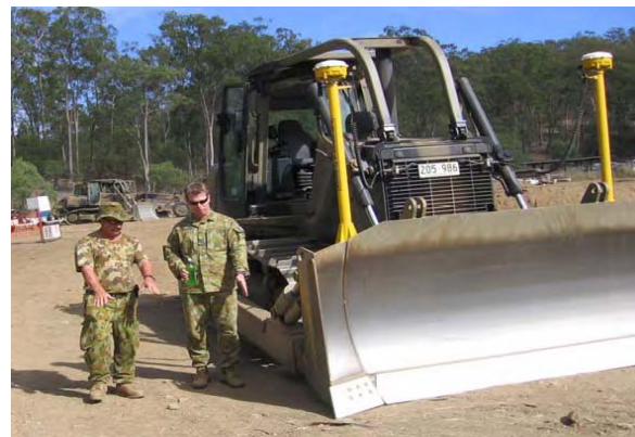
圖 28 工程控制系統於推土機應用實例
