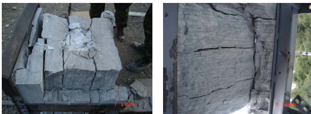
圖 20 150gC-4 炸藥接觸爆炸下大理岩試體破裂情形
