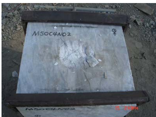
圖 22 50gC-4 炸藥接觸爆炸下大理岩試體破裂情形
