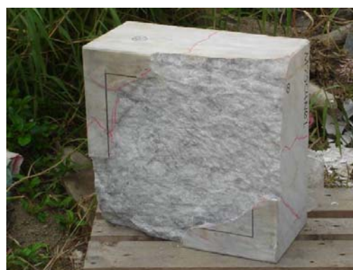
圖 23 75gC-4 炸藥接觸爆炸下大理岩試體背面大片剝落情形
