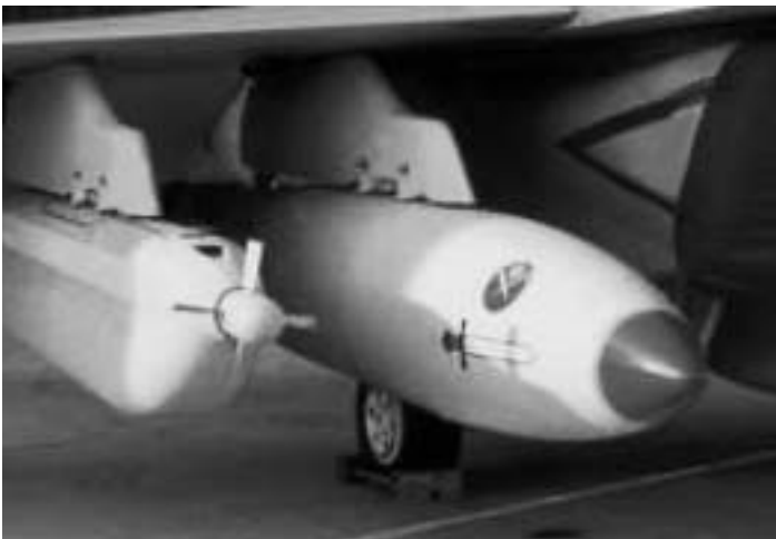
掛於EA-18G機翼派龍下的ALQ-99電子干擾莢艙（左件），由衝壓空氣推動的渦輪機提供獨立電源
