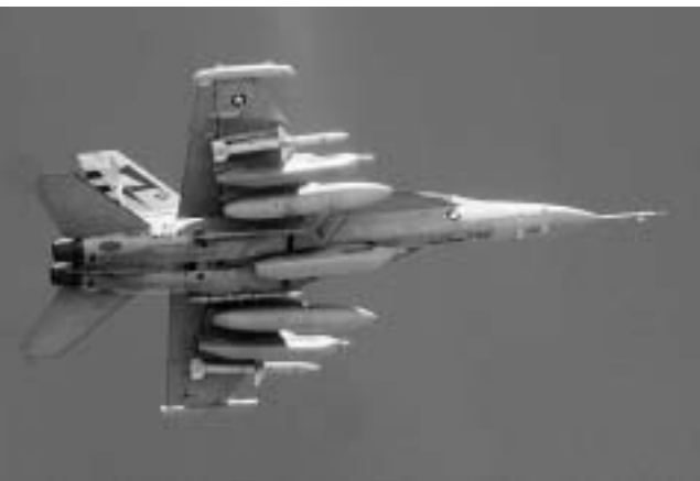
EA-18G強大的任務酬載掛載能力，機腹及機翼下方掛滿各種任務莢艙後，外側派龍還有AGM-88反輻射飛彈
