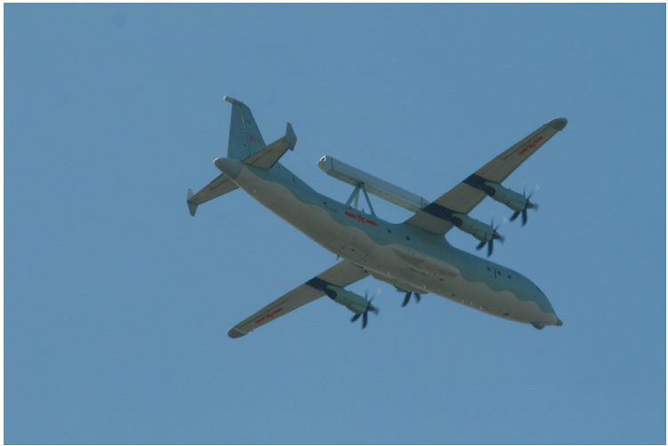
圖2 中共「空警200」預警機採用和瑞典Erieye相近的平衡木雷達系統。
