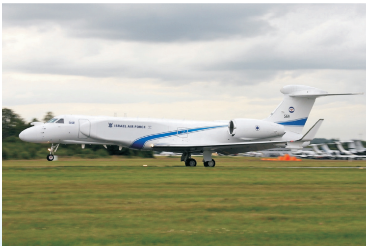
圖5 以色列航太工業使用美製灣流G 550型商用機為載具的CAEW預警系統。
